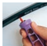
Inserimento di Xeri-Bug™ in un unico passaggio
