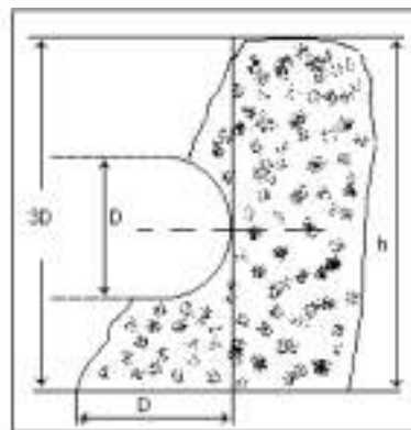
Sezione di ancoraggio per le curve a 45° e 90°
